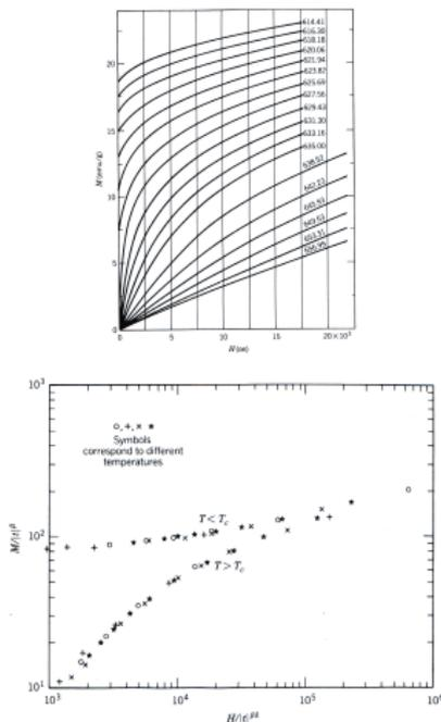
Magnetische Zustandsgleichung von Ni: (a)  $M$  vs.  $H$  (oben); (b)  $\tilde{M}$  vs.  $\tilde{H}$  (unten). Experimentelle Ergebnisse aus 1926 (!); aus Ref. [7.1]
